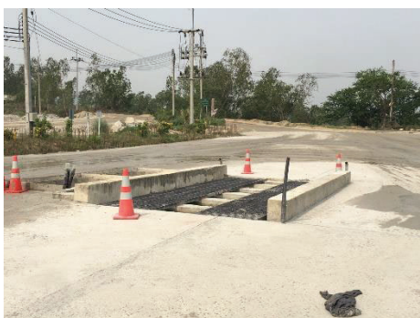
รูปที่ 2-22: ระบบลานล้างล้อรถยนต์ก่อนออกนอกโรงโม่หิน
