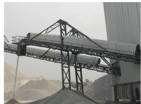
รูปที่ 2-17: อุปกรณ์ปิดคลุมระบบสายพานลำเลียง
