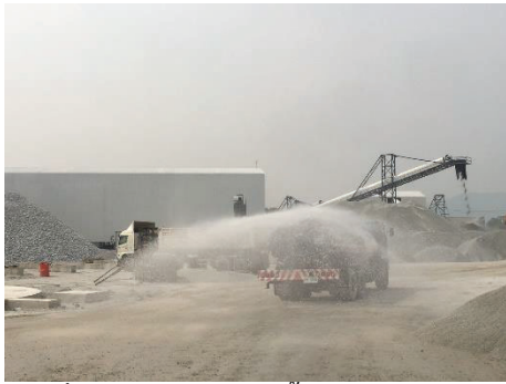
รูปที่ 2-28: การฉีดพรมน้ำบริเวณโรงโม่หิน
