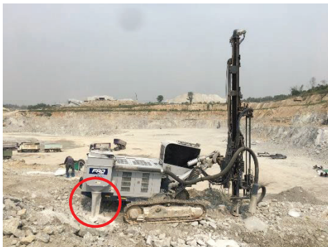
รูปที่ 2-14: รถเจาะรูระเบิดที่มีการติดตั้งแผ่นกรองฝุ่น
